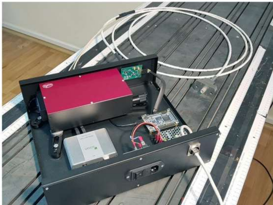
Макет высокотемпературного волоконно-оптического датчика
