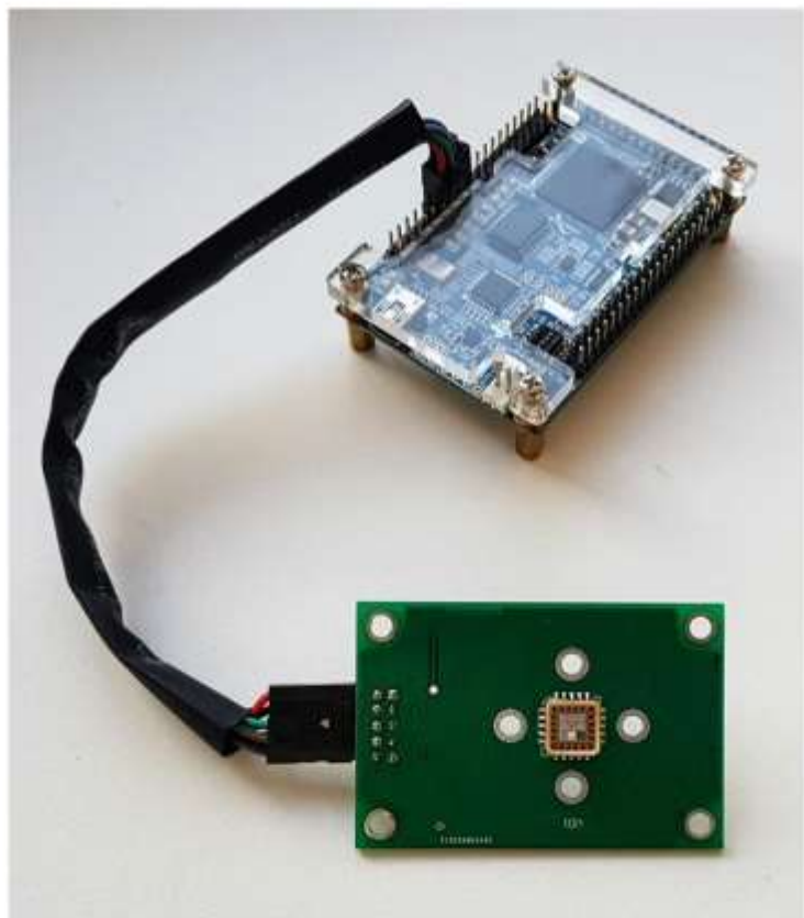
Плата обработки данных и плата с массивом ФПУ
