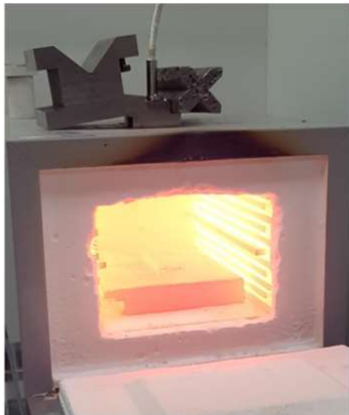
Установка сапфирового стержня в технологической оснастке в ходе испытаний
